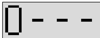
Heslo se skládá ze čtyř číslic. Každá číslice se zadává zvlášť (pomocí kláves [▲] a [▼]), po potvrzení (klávesou [↵]) se změní na pomlčku a přejde se na další. Je-li heslo zadáno správně, přejde regulátor do podmenu, v opačném případě dlouze pípne a vrací se zpět na stejnou položku.
