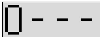
Heslo se skládá ze čtyř číslic. Každá číslice se zadává zvlášť (pomocí kláves [MÓD] a [OVL]), po potvrzení (klávesou [-]) se změní na pomlčku a přejde se na další. Je-li heslo zadáno správně, přejde regulátor do podmenu, v opačném případě dlouze pípně a vrací se zpět na stejnou položku.
